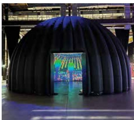
Quickspace presentó su nueva Cúpula de proyección Quickspace en IBTM, junto con su proveedor oficial en España, Magrada Proyectos. Con un diámetro exterior de 10,2m y una altura de 6m, la cúpula ofrece una superficie interior de 64 m<sup>2</sup>, con capacidad para entre 70 y 75 personas sentadas. Está pensada para experiencias efímeras por su facilidad de montaje y desmontaje, y para la proyección de contenidos envolventes.
